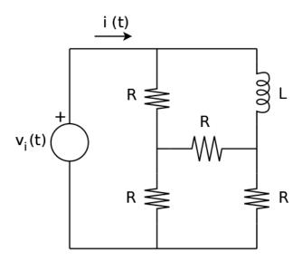
a) Para hallar la impedancia vista por la fuente, pasamos al circuito equivalente en fasores. Podemos identificar previamente un triángulo de resistencias idénticas. Usando la transfiguración sugerida, obtenemos que
