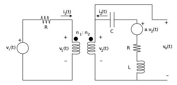
Se considera el circuito de la figura, funcionando en régimen sinusoidal. El transformador es ideal y a es un parámetro a determinar.
