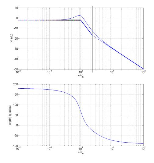
d) La distancia en decibeles, con signo, entre el diagrama real y el asintótico de módulo las calculamos así:
