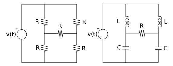
Se consideran los circuitos de la figura, funcionando en régimen sinusoidal.
