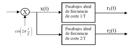
Se considera una señal e(t), de banda acotada W, con  $2W \ll \frac{1}{T}$ . Se inyecta en el sistema de la figura. Hallar la relación <u>exacta</u> entre las energías de las señales  $r_1(t)$  y  $r_2(t)$ .
