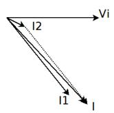
iv) Para compensar la reactiva, colocamos un condensador en paralelo con la fuente. Su valor debe ser tal que entregue la potencia reactiva consumida por el resto del circuito.
