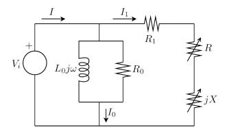
En el circuito de la figura, es posible variar el valor de la resistencia R y la reactancia X, fijando el punto de funcionamiento del circuito. Esta reactancia puede tomar cualquier valor real, en tanto la resistencia es no negativa. Obsérvese que la corriente  $I_0$  es la misma para cualquier punto de funcionamiento. Se tienen los siguientes datos:
