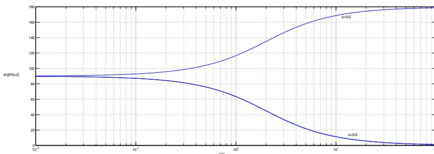
b) Para obtener los Diagramas de Bode asintóticos, realizamos una aproximación asintótica en bandas de frecuencia. Discutimos según la frecuencia  $\omega_1 = \frac{2}{(5-2\alpha)}\omega_0$ , con  $\omega_0 = R/L$ .
