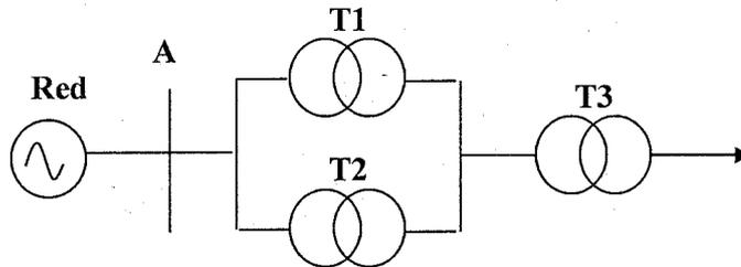
El diagrama unifilar de la figura representa la alimentación a un sector de una planta industrial desde una red de media tensión.
