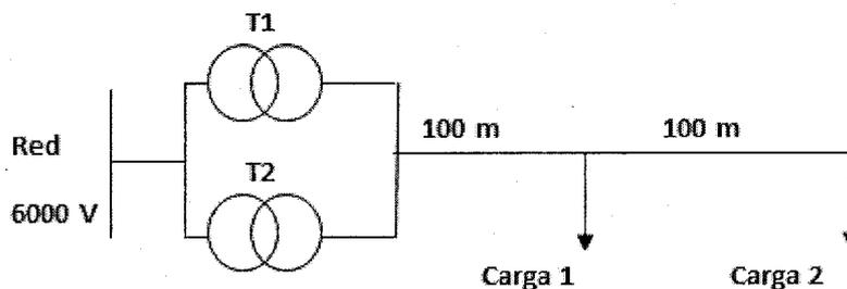
El diagrama unifilar representa la instalación eléctrica de una fábrica la cual se alimenta desde una red de 6 kV, 50 Hz por intermedio de dos transformadores en paralelo (T1 y T2) los cuales reducen la tensión al nivel adecuado para las cargas 1 y 2.
