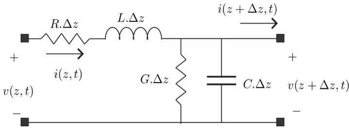
Ecuación para la tensión en la línea:  $\frac{\partial^2 v}{\partial z^2}(z,t) = RG \cdot v(z,t) + [RC + LG] \frac{\partial v}{\partial t}(z,t) + LC \cdot \frac{\partial^2 v}{\partial t^2}(z,t)$
