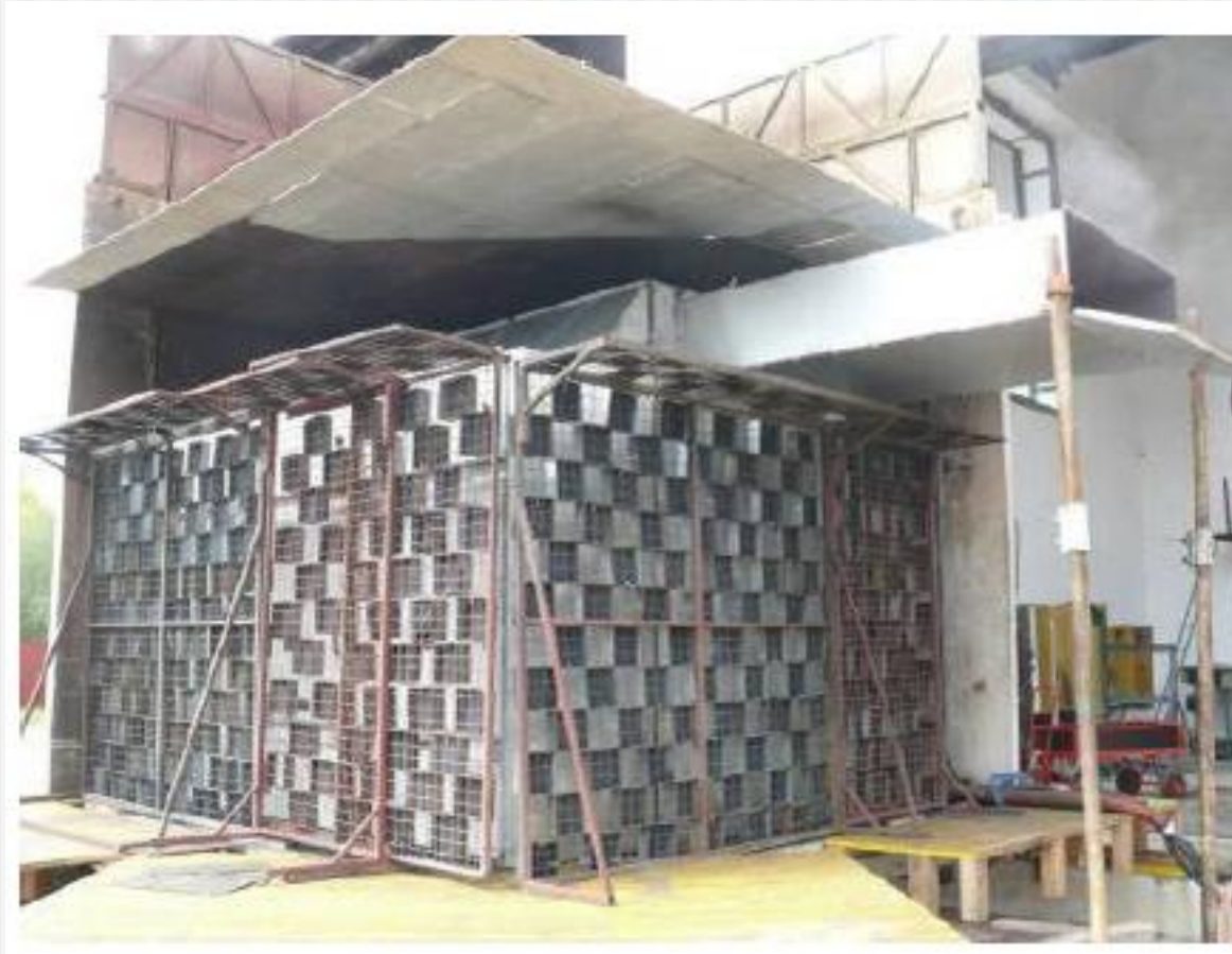
Montaje para ensayo de Arco Interno
