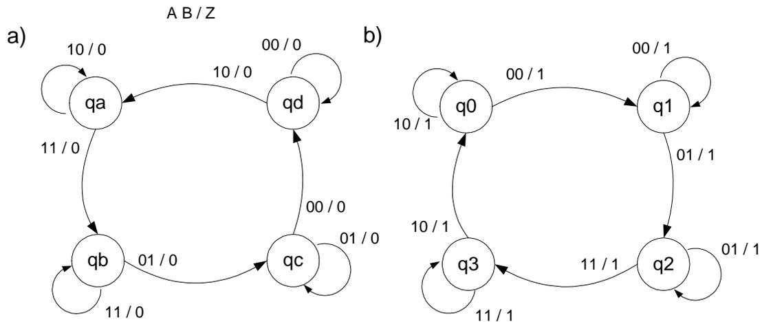
Figura 4 Diagramas de estados con la cinta hacia la: a) izquierda y b) derecha
