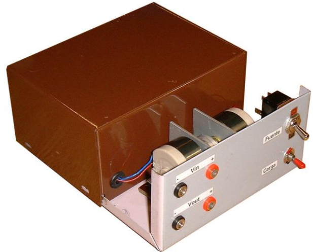
Figura I.1. Caja del par motor-generador.
