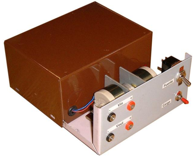
Figura I.1. Caja del par motor-generador.
