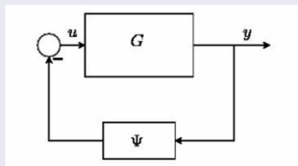
$$\begin{cases} \dot{x}_1 = x_2 \\ \dot{x}_2 = x_1 + u \\ y = 2x_1 + x_2 \\ u = -\text{sat}(y) \end{cases} \Leftrightarrow \begin{cases} \dot{x} = \begin{bmatrix} 0 & 1 \\ 1 & 0 \end{bmatrix} x + \begin{bmatrix} 0 \\ 1 \end{bmatrix} u \\ y = \begin{bmatrix} 2 & 1 \end{bmatrix} x \\ u = -\text{sat}(y) \end{cases}$$
