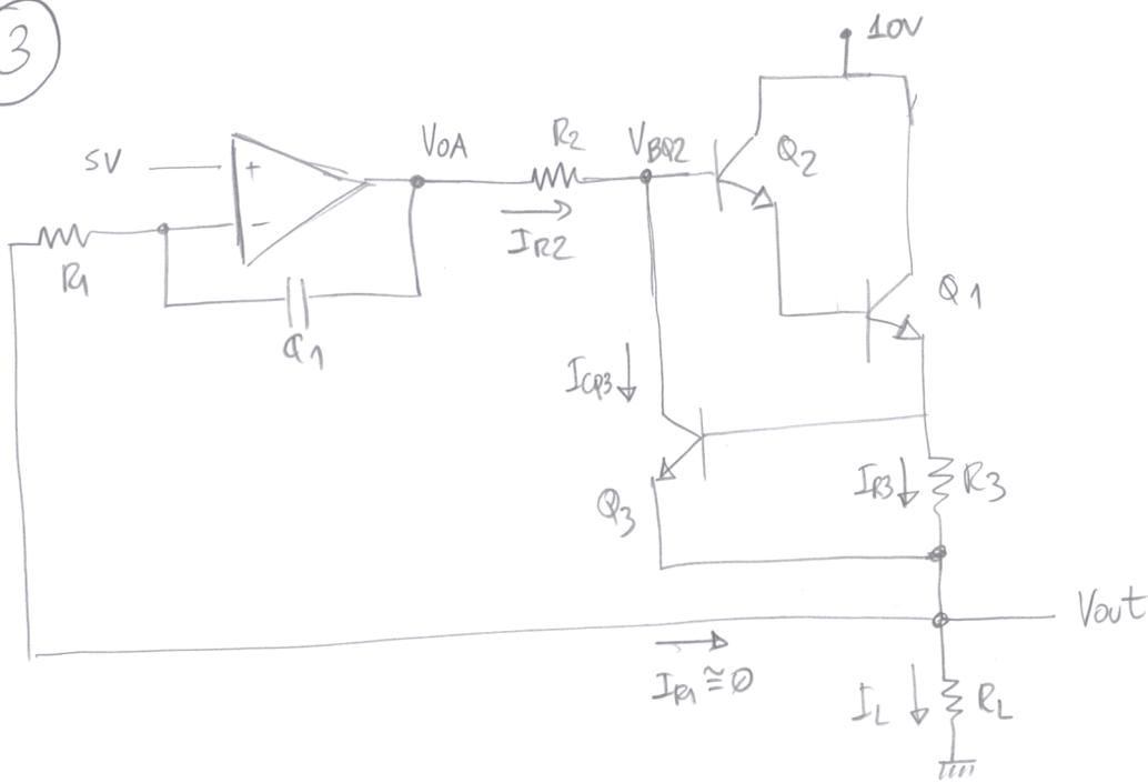
Mientras  $I_{R3} < \frac{V_{BEQ3}}{R3} = 2A$ ,  $Q3$  permanecerá cortado ( $R3$  y  $Q3$  circuito limitador)
