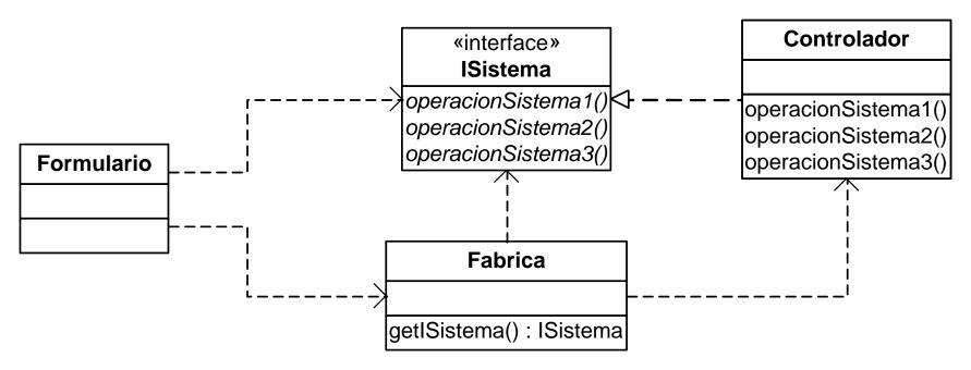
En caso de existir más interfaces del sistema la misma Fábrica puede encargarse de devolver instancias que las realicen
