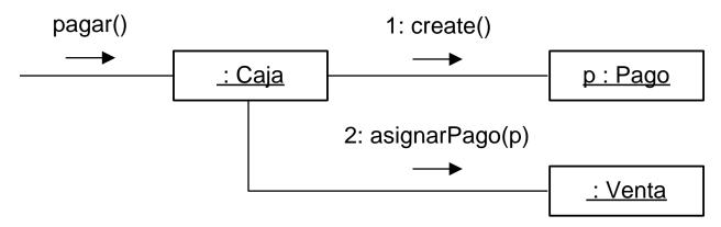
Sin embargo aquí se acopla a Caja con Pago y a Venta con Pago (Caja ya estaba acoplada a Venta)
