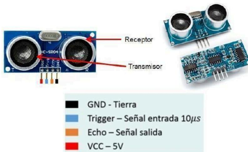
Figura 3: Sensor de ultrasonido HC-SR04.
