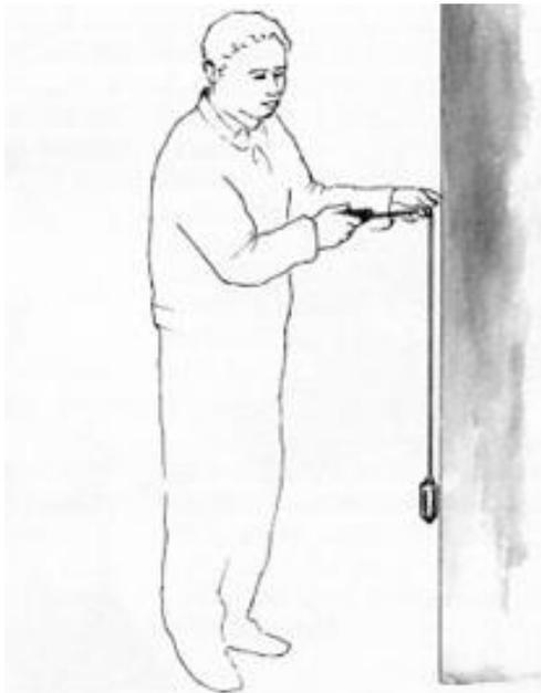
El peso debe estar constituido por una masa metálica homogénea terminada en punta por su extremo libre y constituida de manera que dicha punta, cuando la plomada está suspendida, se encuentre en la prolongación del cordón.
