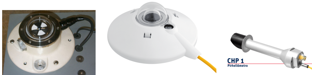
Figura 1.40: Izquierda: Piránometro Eppley Black & White, mod. 8.48. Centro: Piránometro Kipp & Zonen CMP-21. Derecha: Pirheliómetro CHP-1 de Kipp & Zonen. Este aparato se monta en un mecanismo seguidor (pasivo o activo) para realizar medidas continuas de radiación directa.
