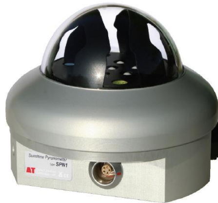
Figura 1.42: Piranómetro SPN-1 de Delta-T devices. Permite medir simultáneamente la irradiancia global y la difusa sin partes móviles ni ajustes periódicos, salvo por la recalibración bi-anual.
