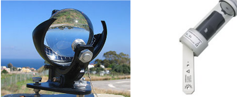
Figura 1.44: Izquierda: Heliógrafo de Campbell-Stokes instalado. Derecha: Registrador moderno de horas de insolación basado en fotodiodos, de Kipp & Zonen.
