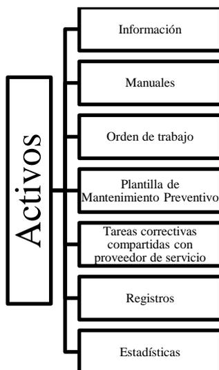
Fig. 1: Información del activo que permite la accesibilidad al historial, a los manuales de servicio y a los informes de reparación, con indicadores de análisis de calidad como herramienta de proyecciones a futuro.
