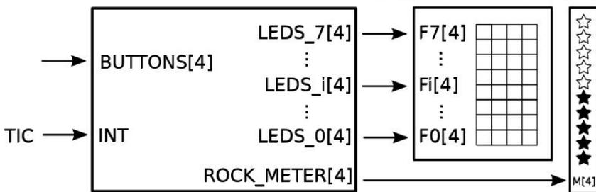
En nuestra versión tendremos solo 4 botones (4 cuerdas) y una matriz (4 x 8) de LEDs como pantalla. Un acorde se representa en una fila de 4 LEDs. Los acordes se desplazan hacia abajo con el avance del tiempo. El jugador debe presionar los botones que se correspondan con el acorde desplegado en la fila de más abajo (**fila 0**) y mantenerlos
