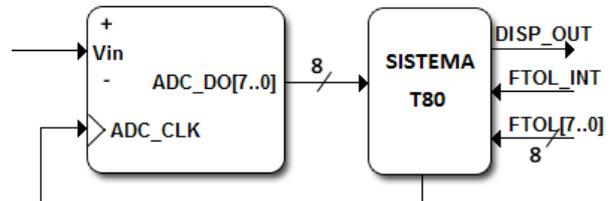
La señal **ADC\_CLK** deberá estar conectada a la salida ZC de un bloque **TIMER**, el cual debe generar un flanco de subida cada **1 ms** o **10 ms** (según se especifica más adelante). Además el **TIMER** debe interrumpir al **T80** para comunicar que hay un nuevo dato disponible (con la prioridad más alta). La frecuencia de reloj del sistema es **fclk = 40,96 MHz (40960 kHz)**. Notar que  $1\text{ ms} = 4096 \times 10 \times 1/\text{fclk}$ .
