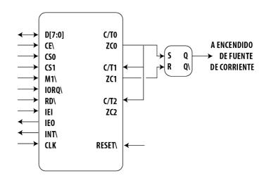
El reloj del sistema es de 1MHz. Notar que 1/1MHz \* 256 = 256us y que 65,280 ms = 256us \* 255
