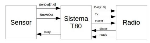
Se desea enviar datos generados por un sensor a través de una radio. Para ello se deberá diseñar el siguiente sistema.
