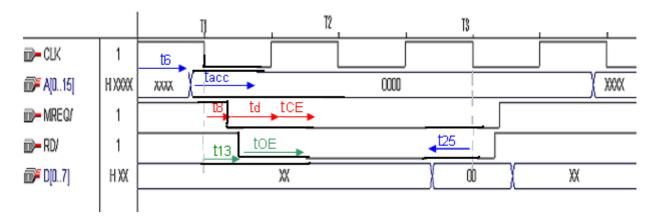
datos de letra: T = 162ns Td max = 30ns datos de cartilla del Z80: t6\_max = 90ns t13\_max = 80ns t8 max = 70ns
