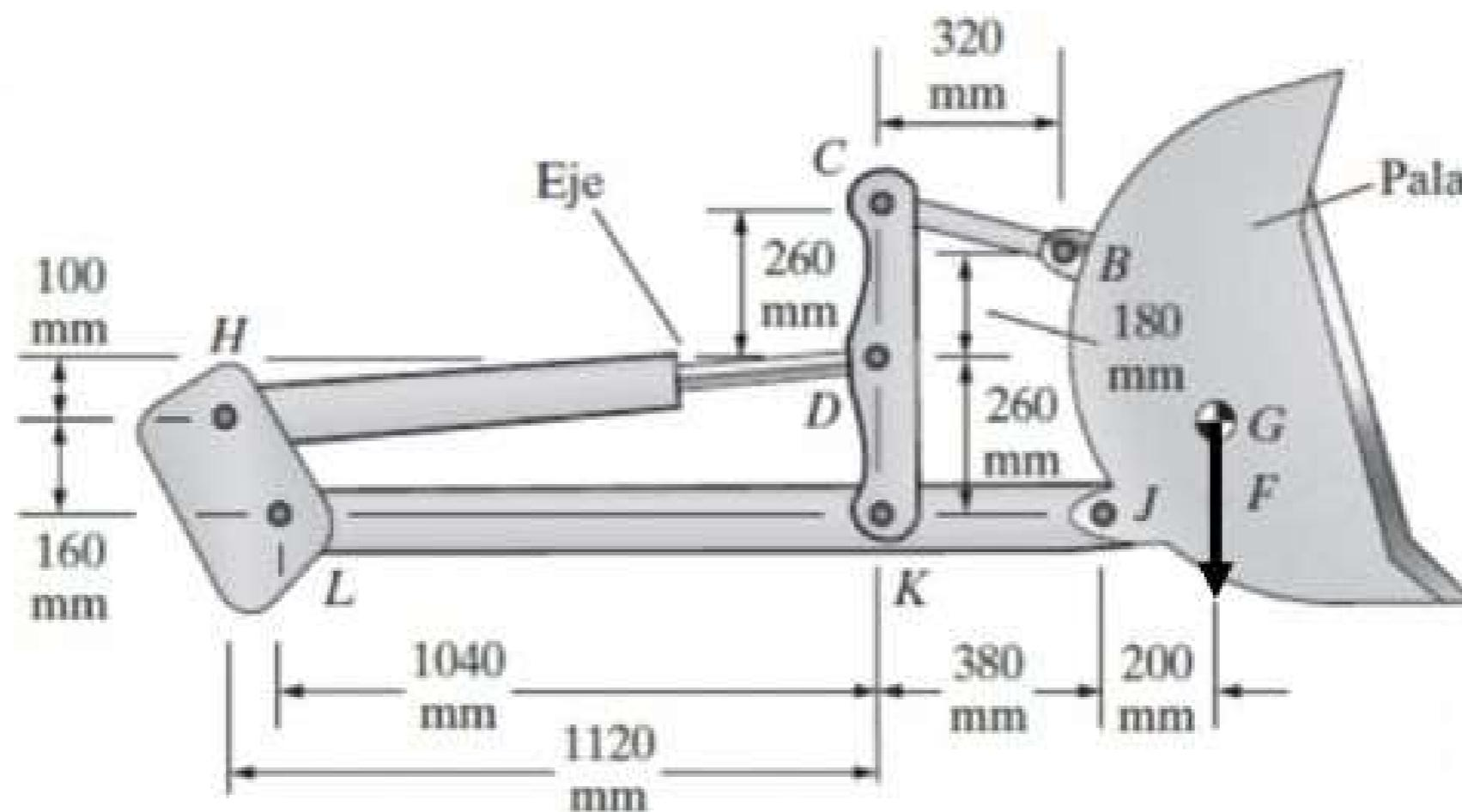
La pala de la figura esta diseñada para elevar cargas cuya acción se puede modelar de forma vertical descendente. Determinar la fuerza ejercida en el pistón si se aplica una fuerza  $F$  equivalente en G a 5000 N.
