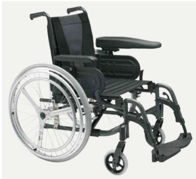
Figura N°4: Imágen ilustrativa del sistema de doble aro.
