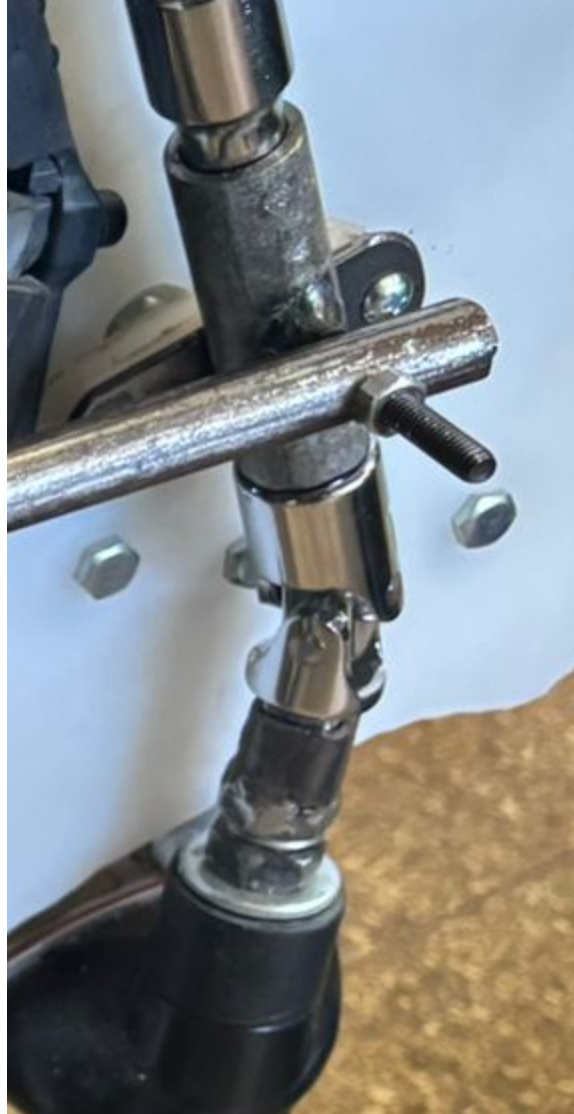
Figura N°14: Acoples a la palanca de impulsión (cruceta y tubo/unión).
