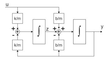
Se puede verificar mediante la linealidad de las integrales que dicho diagrama de bloques representa la ecuación del sistema.
