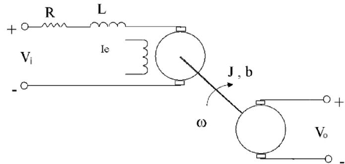
El generador está acoplado al mismo eje y genera el voltaje de salida  $V_o$ , el cual es proporcional a la velocidad angular del eje con una constante de proporcionalidad  $K$  ( $V_o = K\omega$ ).
