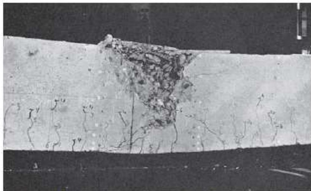
Figura 14.12 b Rotura por agotamiento del hormigón comprimido
