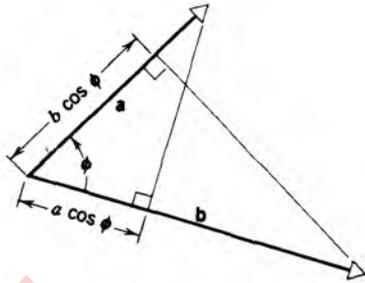
**Figura 16** El producto escalar  $\mathbf{a} \cdot \mathbf{b} (= ab \cos \phi)$  es el producto de la magnitud de un vector (por ejemplo,  $a$ ) y la componente del otro vector en la dirección del primero ( $b \cos \phi$ ).
