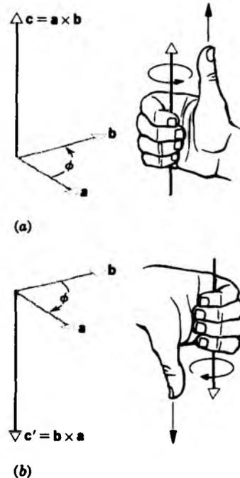
**Figura 17** La regla de la mano derecha para los productos vectoriales. (a) Girar el vector  $\mathbf{a}$  hacia el vector  $\mathbf{b}$  con los dedos de la mano derecha. El pulgar muestra la dirección de  $\mathbf{c}$ . (b) Invertiendo el procedimiento se demuestra que  $(\mathbf{b} \times \mathbf{a}) = -(\mathbf{a} \times \mathbf{b})$ .
