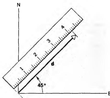
Figura 2 El vector  $\mathbf{d}$  representa un desplazamiento de magnitud 42 m (en una escala en la cual 10 m = 1 cm) en una dirección de  $45^\circ$  al NE.
