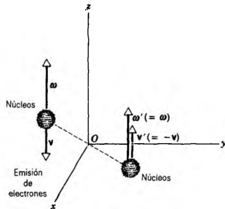
**Figura 20** Un grupo de núcleos girando, representado por un vector de velocidad angular  $\omega$ , emite electrones preferentemente en dirección opuesta a  $\omega$ . En la versión reflejada del experimento, los electrones se emitirán paralelos a  $\omega'$ . El experimento y su imagen reflejada se ven bastante diferentes entre sí, mostrando que la simetría de la reflexión se viola por estas desintegraciones.
