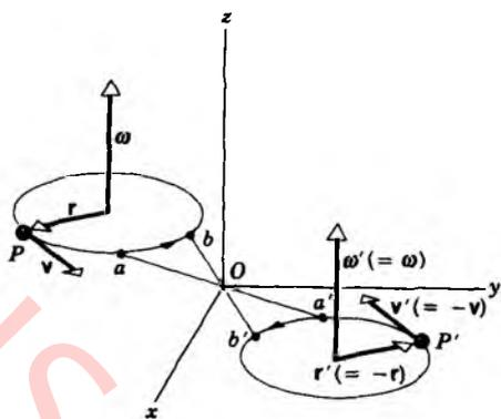
**Figura 19** Una partícula  $P$  moviéndose en círculo es representada por el vector de la velocidad angular  $\omega$ . Si todas las coordenadas se reflejan respecto al origen  $O$ , la partícula “reflejada”  $P'$  gira en un círculo y está representada por el vector de la velocidad angular  $\omega'$ .
