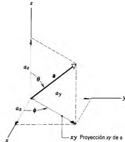
**Figura 7** Un vector  $\mathbf{a}$  en tres dimensiones con componentes  $a_x$ ,  $a_y$ , y  $a_z$ . Las componentes  $x$  y  $y$  se hallan convenientemente dibujando primero la proyección  $xy$  de  $\mathbf{a}$ . El ángulo  $\theta$  entre  $\mathbf{a}$  y el eje  $z$  se llama *ángulo polar*. El ángulo  $\phi$  en el plano  $xy$  entre la proyección de  $\mathbf{a}$  y el eje  $x$  se llama *ángulo azimutal*. El ángulo azimutal tiene el mismo significado aquí que en la figura 6.
