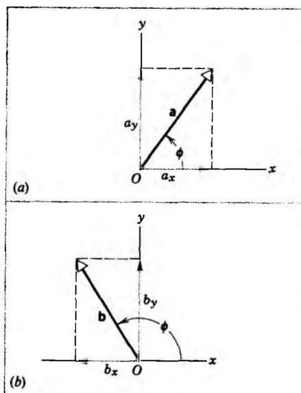
**Figura 6** (a) El vector  $\mathbf{a}$  tiene una componente  $a_x$  en la dirección  $x$  y una componente  $a_y$  en la dirección  $y$ . (b) El vector  $\mathbf{b}$  tiene una componente  $x$  negativa.
