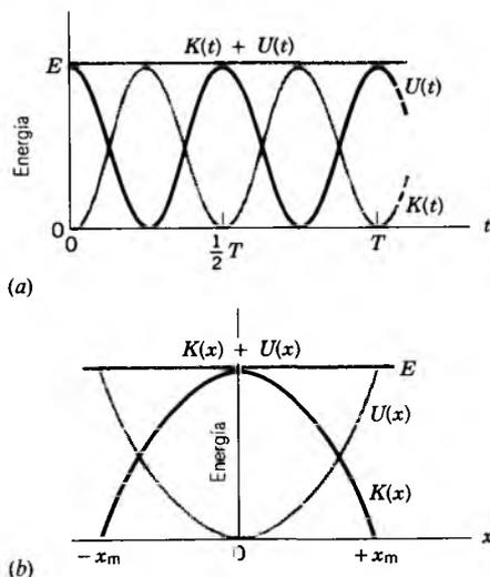
**Figura 8** La energía potencial  $U$ , la energía cinética  $K$ , y la energía mecánica total  $E$  de una partícula que efectúa un movimiento armónico simple se muestran en función de (a) el tiempo y (b) el desplazamiento. Nótese que en (a) las energías potencial y cinética pueden alcanzar cada una sus máximos dos veces durante cada periodo del movimiento. Véase también la figura 6 del capítulo 8.
