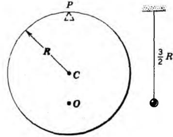
**Figura 12** Problema muestra 5. Un disco pivotado en su borde oscila como un péndulo físico. A la derecha se muestra un péndulo simple con el mismo periodo. El punto  $O$  es el centro de oscilación.
