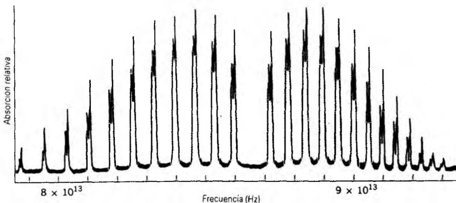
**Figura 23** El espectro de absorción de la radiación infrarroja por el HCl molecular. Cada pico corresponde a un cambio en el movimiento vibratorio de las moléculas. Los pares de picos con espaciamiento pequeño se deben a los dos isótopos del Cl.
