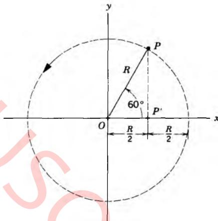
**Figura 15** Problema muestra 8. El radio  $OP$  se mueve desde  $\phi = 0$  en  $t = 0$  hasta  $\omega t = 60^\circ$  en el tiempo  $t$ . La proyección  $P'$  se mueve, correspondientemente, desde  $x = R$  hasta  $x = R/2$ .
