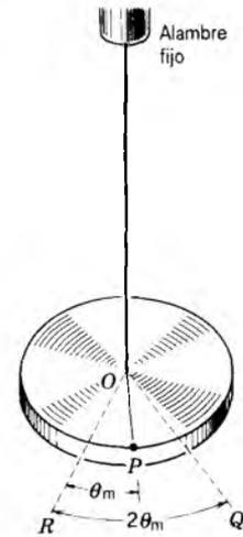
**Figura 9** Oscilador de torsión. La línea que va de  $O$  a  $P$  oscila entre  $OQ$  y  $OR$ , barriendo un ángulo  $2\theta_m$ , donde  $\theta_m$  es la amplitud angular del movimiento.
