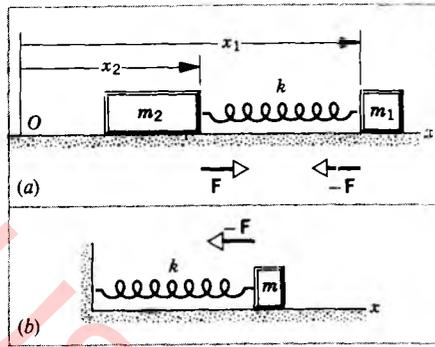
**Figura 22** (a) Dos cuerpos oscilatorios de masas  $m_1$  y  $m_2$  unidos por un resorte. (b) El movimiento relativo puede ser representado por la oscilación de un solo cuerpo que tenga la masa reducida  $m$ .
