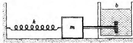
**Figura 18** Representación de un oscilador armónico amortiguado. Consideramos que el cuerpo oscilatorio (de masa  $m$ ) está unido a una tablilla sin masa sumergida en un fluido, donde experimenta una fuerza de amortiguamiento viscoso  $-bv$ . No consideramos, en cambio, la fricción por deslizamiento en la superficie horizontal.
