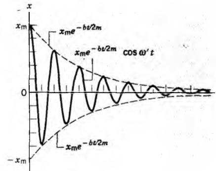
**Figura 19** Movimiento armónico amortiguado. El desplazamiento  $x$  se grafica contra el tiempo  $t$  considerando que la constante de fase  $\phi$  sea 0. El movimiento es oscilatorio, pero la amplitud disminuye exponencialmente con el tiempo.
