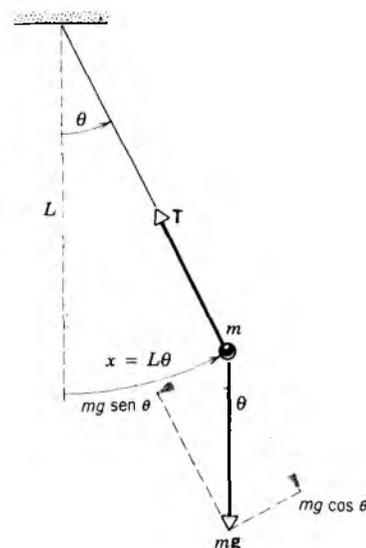
**Figura 10** El péndulo simple. Las fuerzas que actúan sobre el péndulo son la tensión  $T$  y la fuerza gravitatoria  $mg$ , la cual se descompone en sus componentes radial y tangencial.
