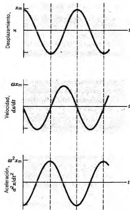
**Figura 7** El desplazamiento, la velocidad, y la aceleración de un oscilador armónico simple, según las ecuaciones 11.
