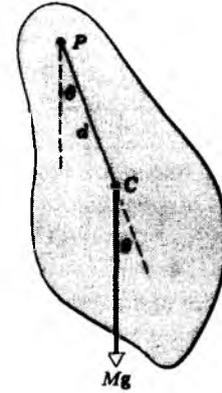
Figura 11 Un péndulo físico. El centro de masa está en C, y el pivote está en el punto P. El péndulo es desplazado un ángulo  $\theta$  desde su posición de equilibrio, la cual existe cuando C cuelga directamente debajo de P. El peso  $Mg$  proporciona la torca de restitución.
