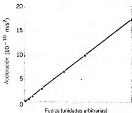
**Figura 20** Resultados de un experimento reciente para probar si la segunda ley de Newton es válida para aceleraciones pequeñas, menores de  $10^{-9} \text{ m/s}^2$ . La línea recta demuestra que la aceleración es proporcional a la fuerza aplicada hasta  $10^{-10} \text{ m/s}^2$  y, por tanto, la ley de Newton es válida aun para esas pequeñísimas aceleraciones.
