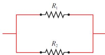
Suponga que se fija la resistencia  $R_2$  con  $R_2 = 10$  ohms, calcule la función  $f : \mathbb{R}^+ \rightarrow \mathbb{R}$  donde  $f(x) =$  la resistencia de tomar  $R_1 = x$  ohms.
