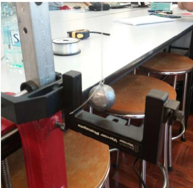
El otro extremo de la tanza con la bolita de plomo colgando, y un sensor infrarrojo ubicado a una altura adecuada para que pueda percibir el movimiento de la bola y así, mediante un aparato que mostraremos a continuación, poder calcular el período del péndulo.
