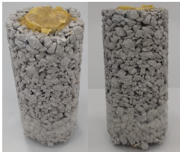
Figura 1.2: probeta de hormigón permeable con material acoplante (cera de abeja) en una de sus caras
