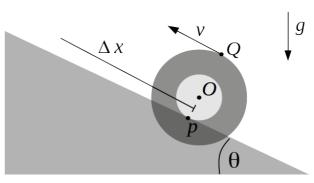
punto Q del carrete (punto más alejado del plano inclinado) tiene una velocidad v como se ilustra en la figura. El carrete siempre rueda sin deslizar (con respecto al punto p). ¿Cuál es la distancia  $\Delta x$  que recorre el carrete con respecto a su posición inicial cuando alcanza su altura máxima?
