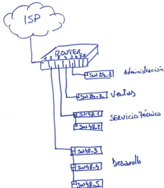
Se configuran 5 de las 8 bocas con cada una de las redes definidas. En cada subred se configura la primera dirección a la interfaz correspondiente del router.
