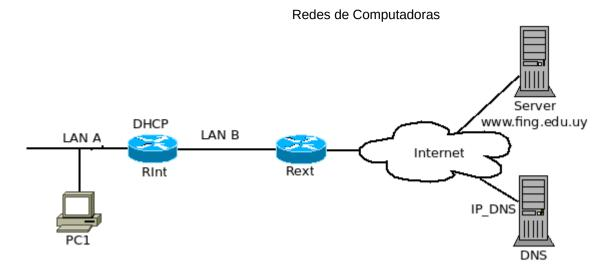
La red posee dos segmentos LAN A y LAN B, conectados por un router Interno (RInt). El segmento LAN B está conectado a Internet por un router Externo (RExt).
