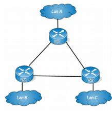
En la red de la figura, se sabe que se necesitan 63 direcciones IP para satisfacer la LAN A, 14 direcciones IP para la LAN B, y 50 direcciones IP para la LAN C. Se asume que las interfaces de los routers están incluidos en las direcciones IP necesarias para cada subred.
