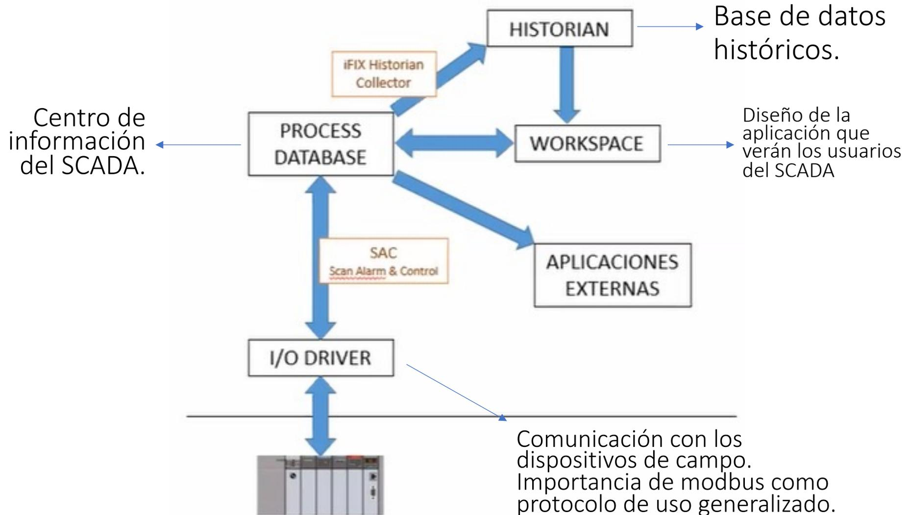
Process database: Estado en tiempo real de todas las variables monitoreadas. Programación de alarmas y clasificación entre otras cosas.
