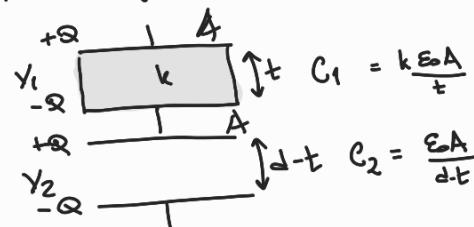
Capacitores  $C_1, C_2$  en serie:  $\Delta V = V_1 + V_2$
