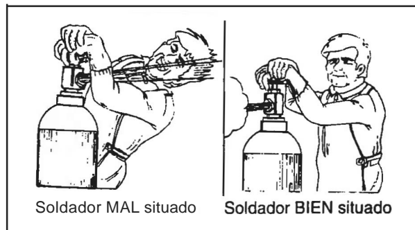
FIGURA 7.6: SITUACIÓN PARA EL PURGADO DE BOTELLAS
