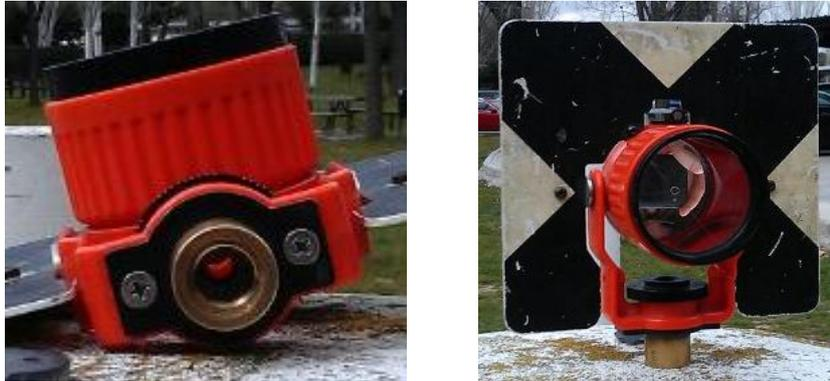
*Imagen 2.4.1.5. Prisma SP12A y anclaje con rosca de 3/8 pulgadas*
