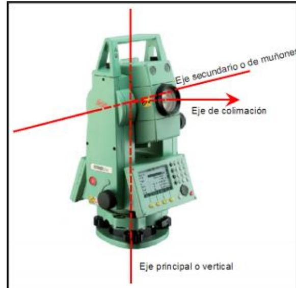
*Imagen 2.4.1.4. Eje de colimación de una estación total.*
