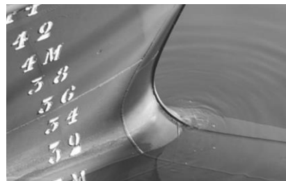
Fig. 6 - Marcas de Calado en la Proa
