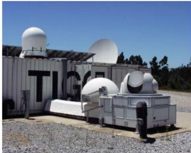
telescopio óptico, apertura de 50 cm
