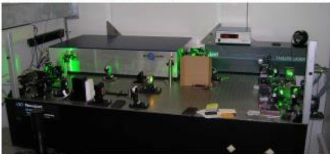
sistema láser system, 15mJ, 40ps, 100Hz
