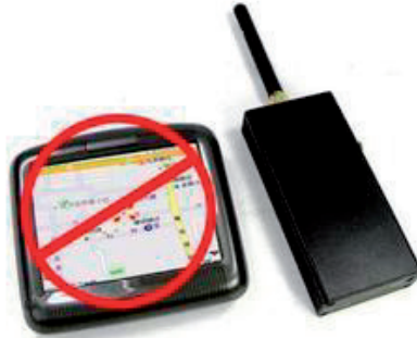
Figura 7.6 Jammer o inhibidor de señal GNSS
