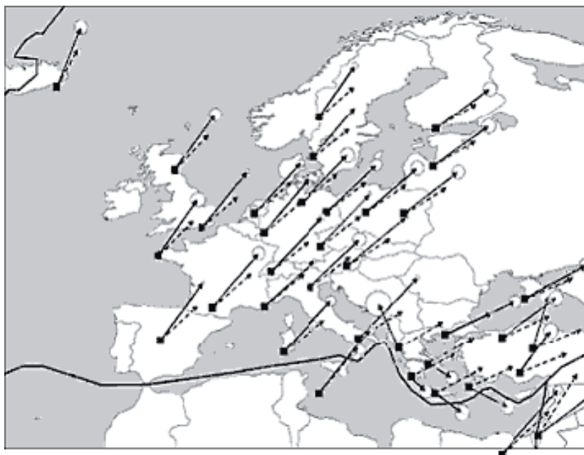
Figura 2.9. Desplazamiento de ETRFYy.las de ITRF (IGN.Be) Velocidades para Europa en ITRF y con NUVEL 1A
