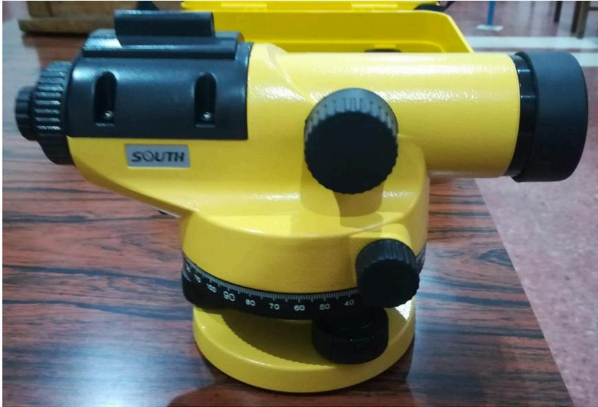
*Imagen 6 - Nivel Óptico (usamos dos al ser una nivelación simultánea, el N5 y el N10).*
