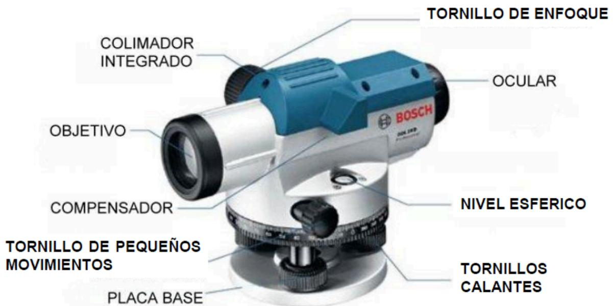
*Imagen 3 - Composición de un Nivel Óptico.*
