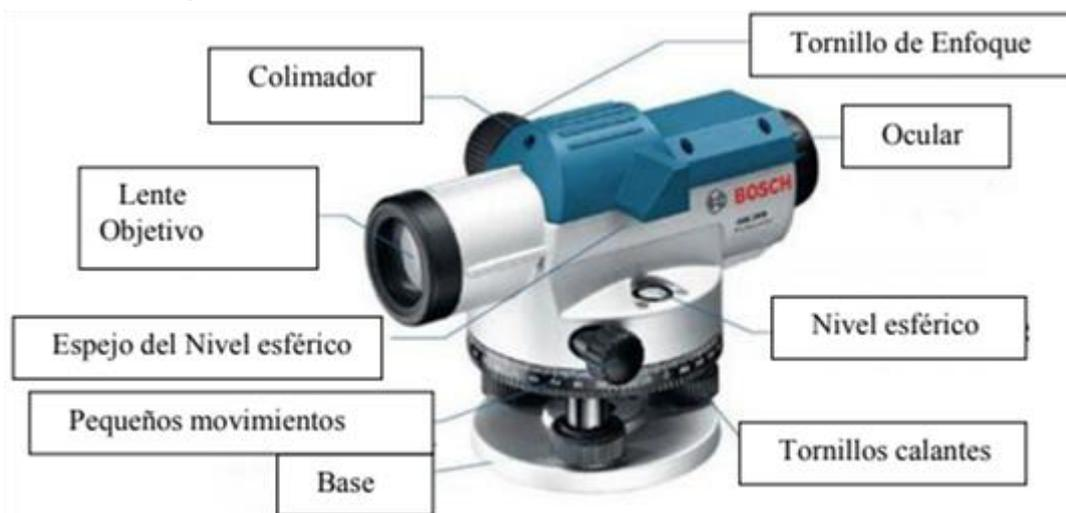
*Imagen 4 - Composición de un Nivel Óptico.*
