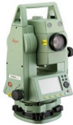
Imagen 4: Estación Total (Leica 407, fue la utilizada en la práctica)
