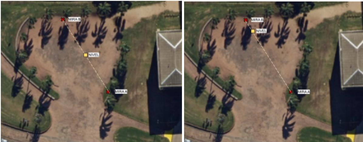
Figura 5. Croquis del segmento utilizado. A la izquierda el nivel equidistante a las miras y a la derecha a 1 metro de la mira B.
