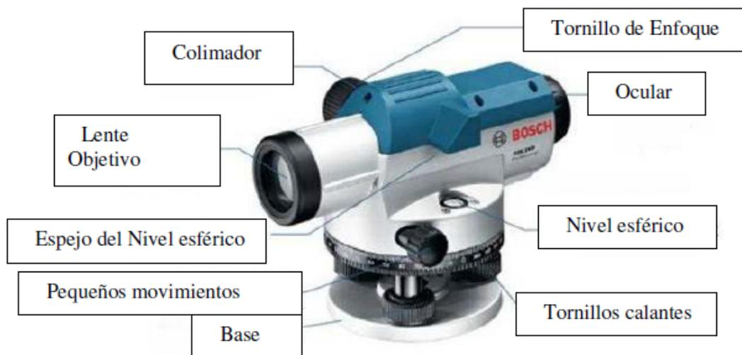
*Figura 2: componentes principales de un nivel automático.*
