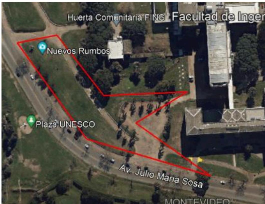
*Imagen 12 - Área de trabajo y figura que representa el trayecto de la nivelación cerrada.*
