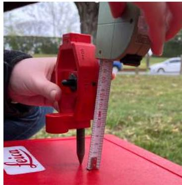
Imagen 9. Medición de la altura del prisma.
