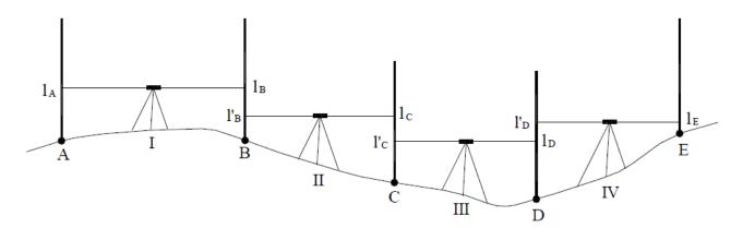
Sean A y E los puntos del terreno cuyo desnivel se quiere hallar, siendo imposible realizarlo desde una sola estación del instrumento. Para ello se hace necesario entonces efectuar una serie estaciones en puntos intermedios, I, II, III..., hallando luego los desniveles parciales en cada una de ellas mediante el método del punto medio.
